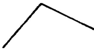
b) Winkel als Ebenenteil, der von zwei geraden Linien mit gemeinsamem Anfangspunkt begrenzt wird. Anstelle eines Bogens kann der Ebenenteil auch durch eine Schraffur angedeutet werden. (Abb.)
